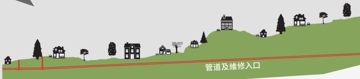
4. 挖渠機將建造管道最長的部分並鋪設與地下深處。兩端的井槽讓承包商能啟動(#1)及取回(#7)挖渠機。
