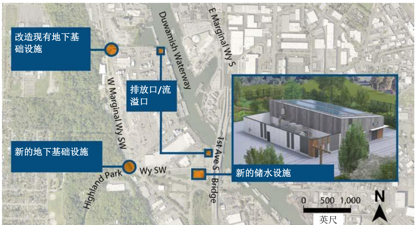
新建储水槽将有助于减少附近两处排放口的溢流情况
