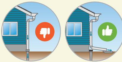
断开屋顶排水管或地基排水管与下水道的连接。在大多数地方，这类排水管不应与下水道连接。
